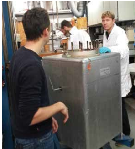
Drukhydrolysereactor van de Universiteit van Brandenburg (BTU) om luiers te recycleren. Links dr. Marco Burkhardt (BTU) en rechts Jelle Duindam (Elsinga Beleidsplanning en Innovatie BV).
